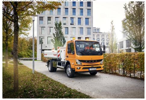
Ein elektrischer »eCanter 9C18e« mit Abrollkipper von Unsinn (Bild: Daimler Truck).
