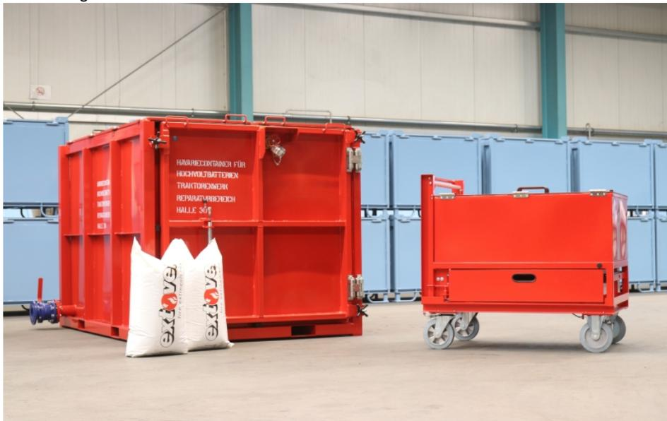
Havariebehälter zur Bergung und zur Lagerung von Lithium-Energiespeichern (Bild: Paul Müller).
