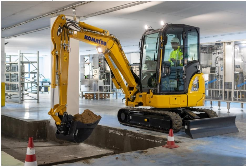
Der Kurzheck-Minibagger mit 1020 mm Schwenkradius ist optimal für emissionsarme Baustellen im urbanen Raum, oder im Indoor-Bereich geeignet (Bild: Komatsu).
