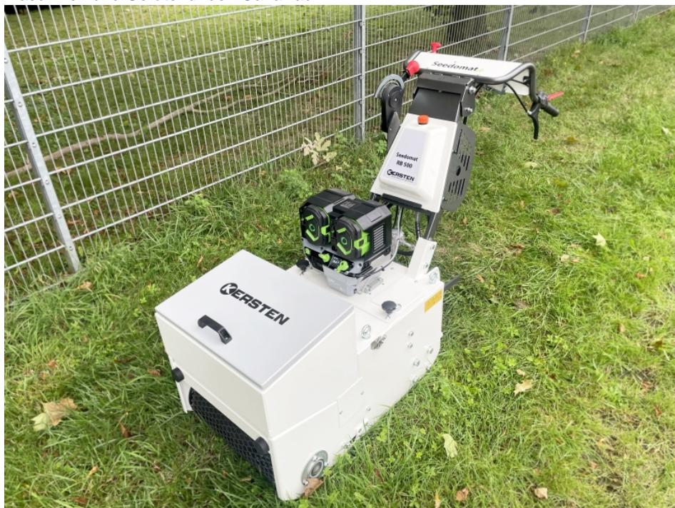
Die elektrische Rasenbaumaschine Seedomat e von Kersten ermöglicht einen emissionsfreien und geräuscharmen Einsatz (Bild: Kersten).
