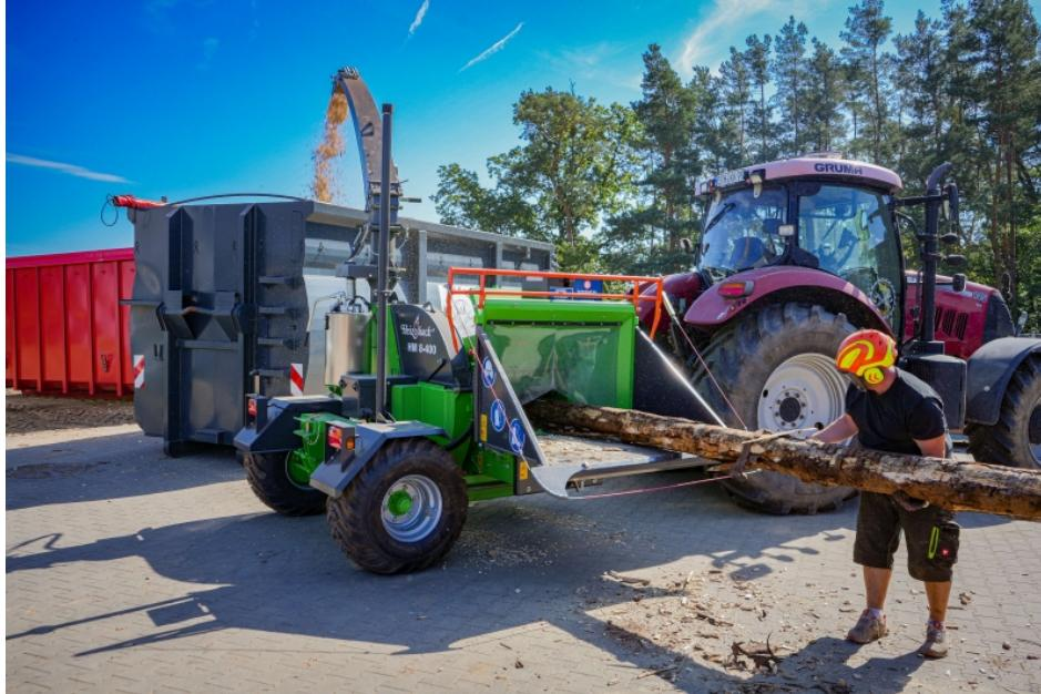
Eine Leistungsklasse über dem »HM 6-300« liegt zum Beispiel der »HM 8-400« auf Einachsfahrgestellt für Stämme bis 400 mm Durchmesser (Bild: Heizomat).
