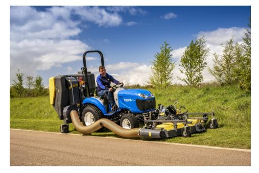
Mähen in der Front, im Heck oder im Zwischenachsbereich – mit dem Boomer ergibt sich immer die perfekte Lösung für Ihre Anwendung (Bild: CNH / New Holland).
