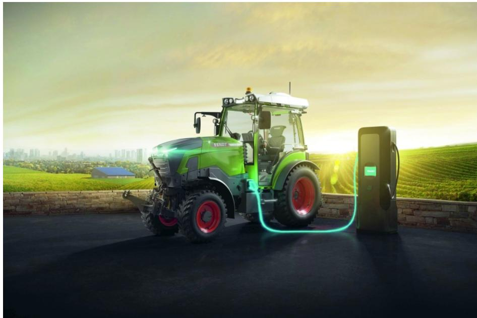
Die CCS2-Steckdose ermöglicht das Laden über Wechselstrom bis 22 kW. Sogar das Schnellladen bis 80 kW über Gleichstrom ist mit dem Elektro-Fendt möglich. (Bild: Fendt-Agco).
