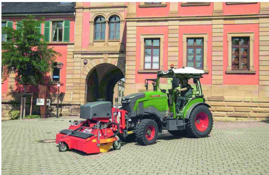
Der Fendt »e100 V Vario« arbeitet leiser als Maschinen mit einem konventionellen Diesel-Motor und verlängert so die Einsatzdauer in geräuschsensiblen Bereichen (Bild: Fendt-Agco).
