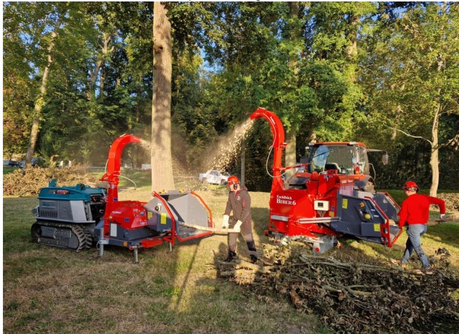
Links ein »Biber 2-15« mit Dreipunktanbau an eine Forstraupe und rechts ein »Biber 6« mit Zapfwellenantrieb im Heckanbau an einen Kommunaltraktor (Bild: Eschlöök).
