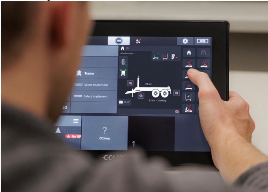
Ein speziell auf Krampe abgestimmtes System wurde entwickelt. Natürlich können die Funktionen auch über jedes andere ISOBUS-Terminal geregelt oder über AUX-N ISOBUS-Bediengeräte wie Traktor-Fahrhebel oder Joysticks anderer Hersteller angesteuert werden (Bild: Krampe).
