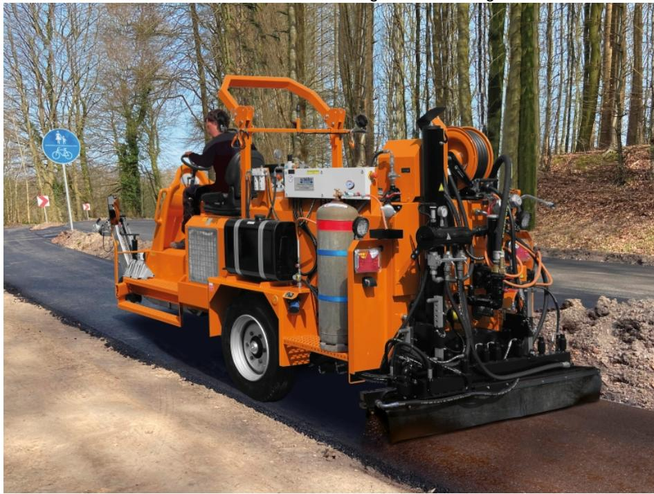
Die Bitumenvorspritzmaschine »BSM-SF« transportiert, temperiert und verspritzt alle üblichen Bitumenklassen, welche keiner Gefahrenklasse unterliegen (Bild: schäfer technic).
