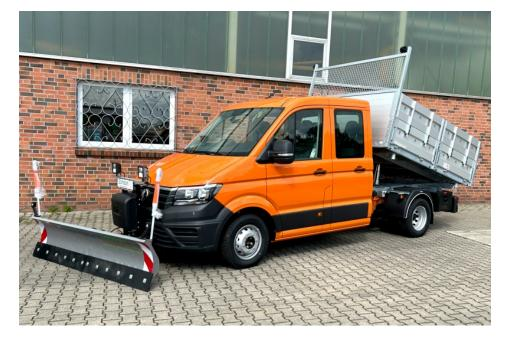
VW Crafter mit Schneeschild, Zusatzbeleuchung und Kipperaufbau (Bild: Schoon).
