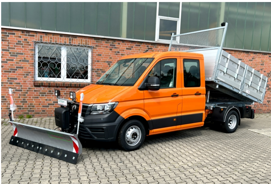
VW Crafter mit Schneeschild, Zusatzbeleuchtung und Kipperaufbau (Bild: Schoon).
