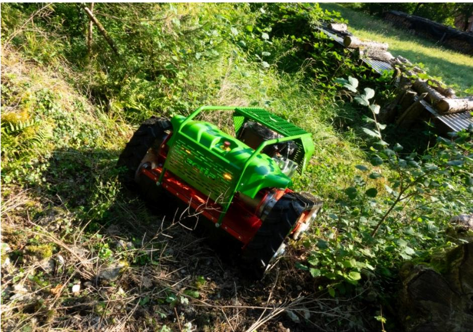
Der optionale Astabweiser erlaubt auch den Einsatz in dichterem Bewuchs (Bild: Agria).
