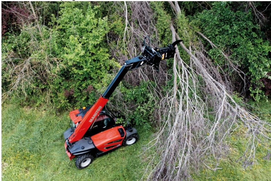
Für die Manitou Teleskoplader gibt es umfangreiches Anbauprogramm des Hersteller – hier mit einer Astschere (Bild: Manitou).
