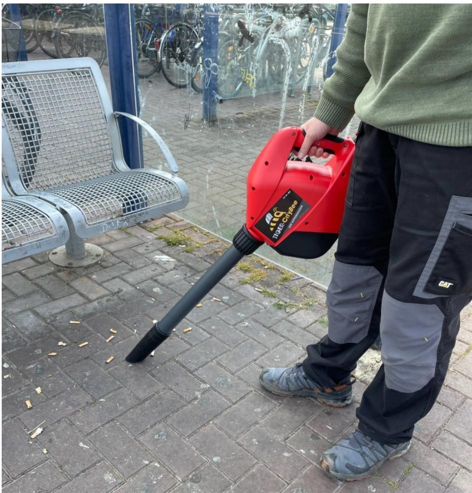
Handlich und saugstark: »CityBee« – der Kippensauger. Das Akkugerät sammelt Problemabfälle wie Zigarettenkippen, Kronkorken usw. durch einen gezielten, punktuellen Luftsog ein (Bild: Tiger).
