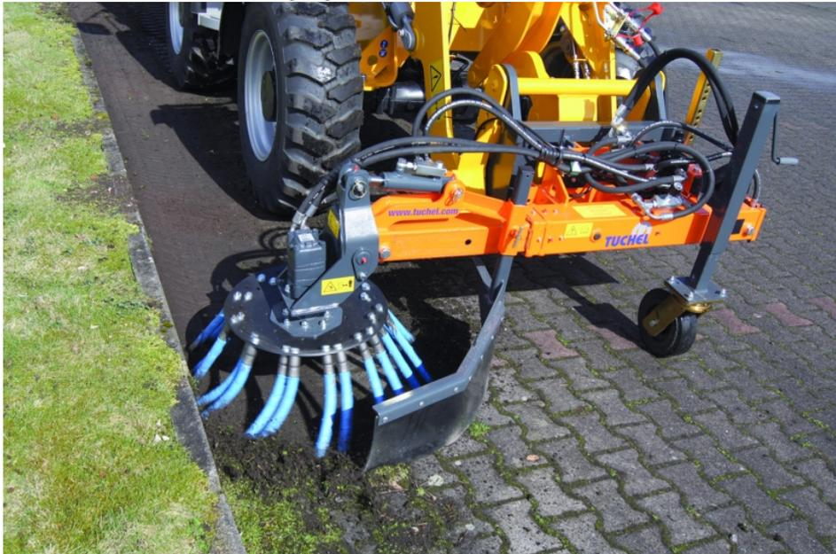
Tuchel hat eine neue Wildkrautbürste »WB 750« vorgestellt. Über die variable Seitenverschiebung ist sie an verschiedenen Trägerfahrzeugen einsetzbar (Bild: Tuchel).
