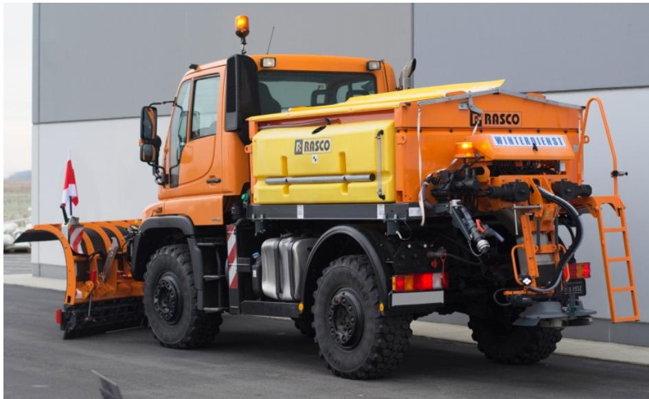
Der Trocken- und Feuchtmittelstreuer Rasco »SOLID XF« ist eine Modellvariante der »SOLID«-Serie und speziell auf kommunale Unimog-Fahrzeuge zugeschnitten (Bild: Wilmers Kommunaltechnik).
