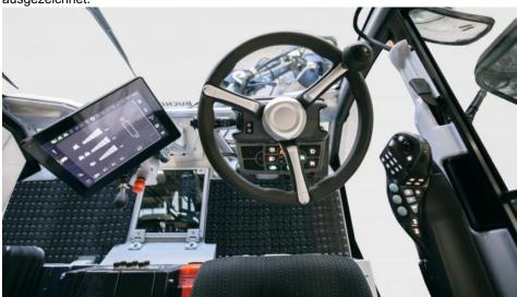
Die komplett neu gestaltete Kabine der »CityCat VR50e« mit Voll-LED-Beleuchtung, Zentralverriegelung und Rundumverglasung bietet dem Fahrer ein Maximum an Komfort und Sicherheit sowie einen modernen Arbeitsplatz (Bild: Bucher Municipal).
