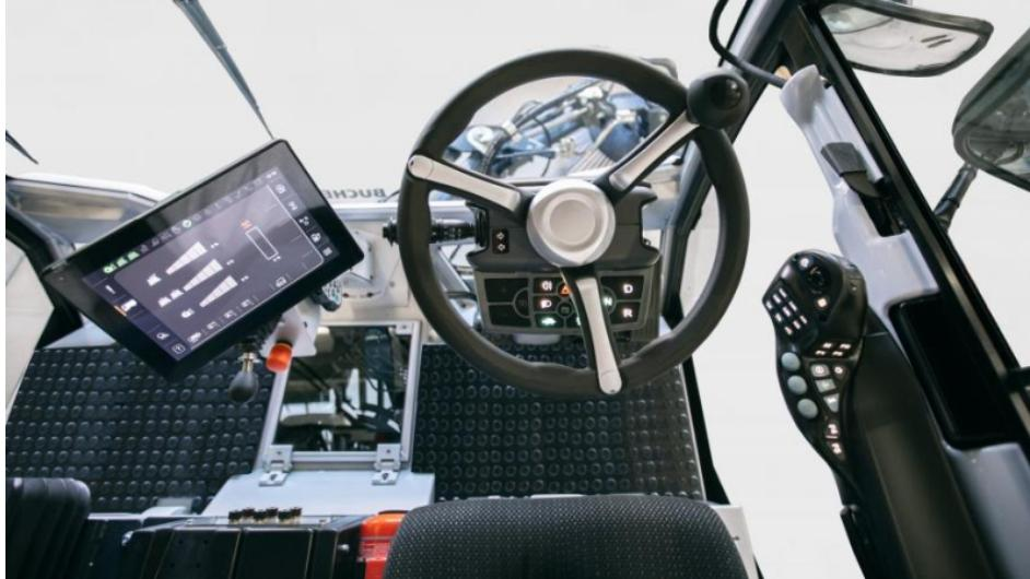
Die komplett neu gestaltete Kabine der »CityCat VR50«-Serie verfügt über eine Voll-LED-Beleuchtung. Zentralverriegelung und Rundumverglasung bieten dem Fahrer einen modernen Arbeitsplatz und ein Maximum an Komfort und Sicherheit. (Bild: Bucher Municipal).
