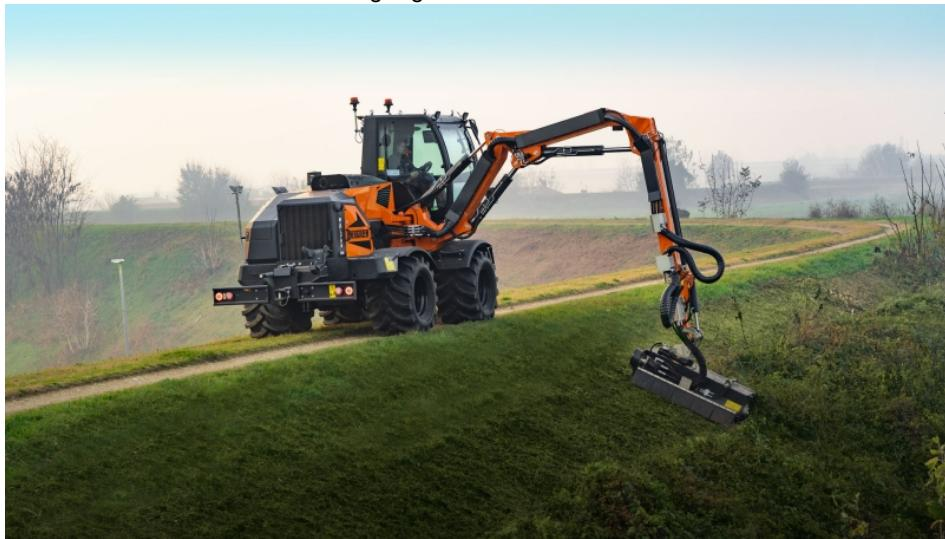
Aus der Schmiede von Energreen stammt der Geräteträger »ILF Alpha« – hier als Freischneider mit Multifunktionsausleger im Einsatz (Bild: Energreen).
