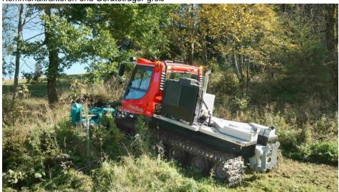
Niedriger Schwerpunkt und geringer Bodendruck – der »PistenBully GreenTech« ist ideal geeignet, um überall dort zu arbeiten, wo die Umstände extrem ausfallen (Bild: Kässbohrer)
