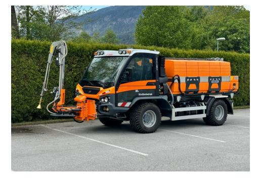
Vielseitig einsetzbar in der Stadt und im Gelände: Mit seiner Leistung von 100 kW (136 PS) und einem Gesamtgewicht von bis zu 10 t) ist der »VT 470 Vario« für jeden Einsatz bereit (Bild: Aebi Schmidt).
