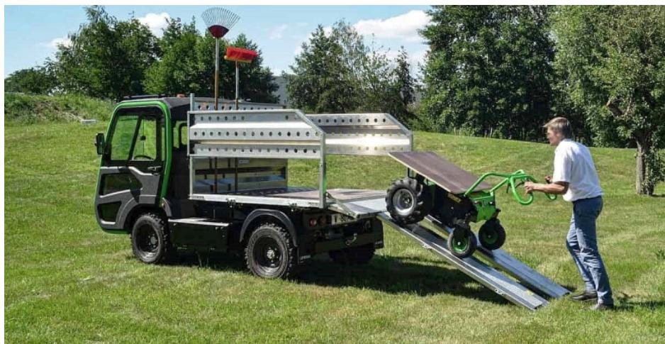
Ein cleveres und praktisches Detail ist die Intergration der Laderampen in der Seitenwände (Bild: Etesia).
