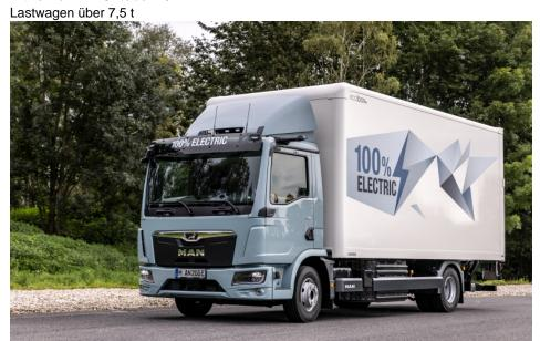
Neuer MAN »eTGL« mit bis zu 6,6 Tonnen Nutzlast, 235 Kilometern Reichweite und nur rund 30 Minuten Ladedauer (Bild: MAN).
