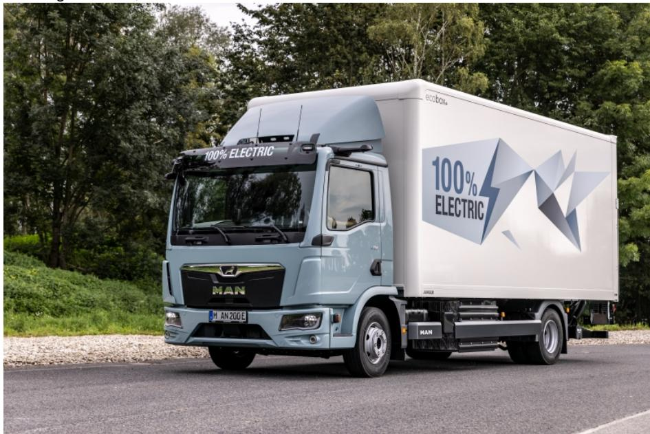
Neuer MAN »eTGL« mit bis zu 6,6 Tonnen Nutzlast, 235 Kilometern Reichweite und nur rund 30 Minuten Ladedauer (Bild: MAN).
