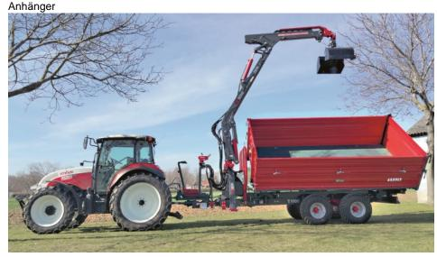
Ein Kipper, den es in zwei Varianten gibt: Zum einen mit Kran und zum anderen als Aufsatzkipper für Rückewagen (Bild: Beha Bau- und Forsttechnik).
