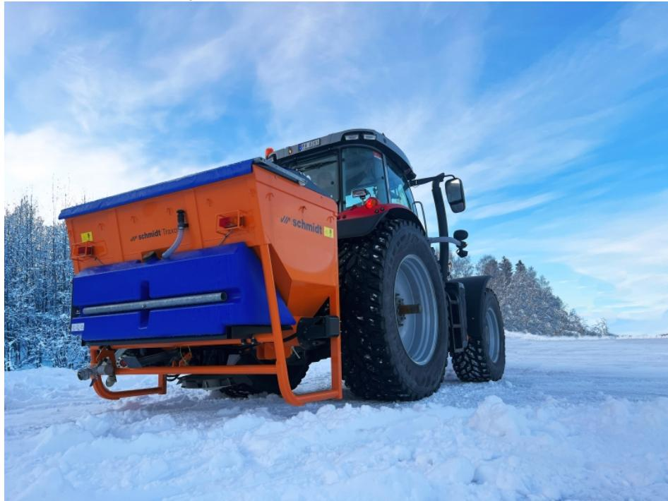
»Traxos«-Anbau-Streumaschine mit Feuchtsalzeinrichtung (Bild: Aebi Schmidt).
