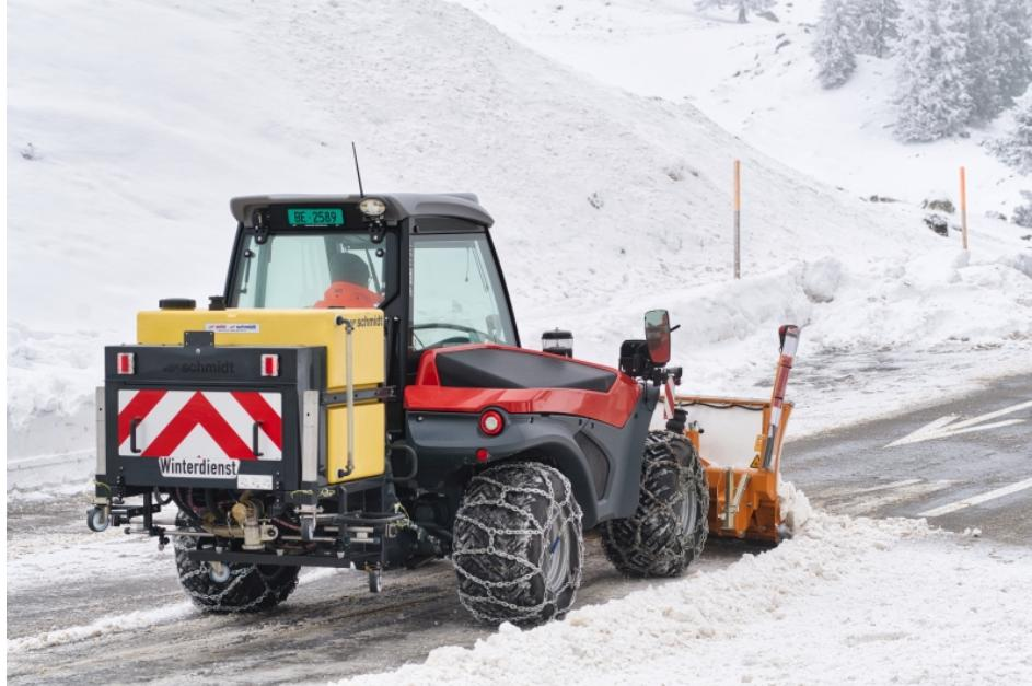
Der "CSP"-Sprüher montiert an einem Aebi Terratrac »TT 211+« (Bild: Aebi Schmidt).
