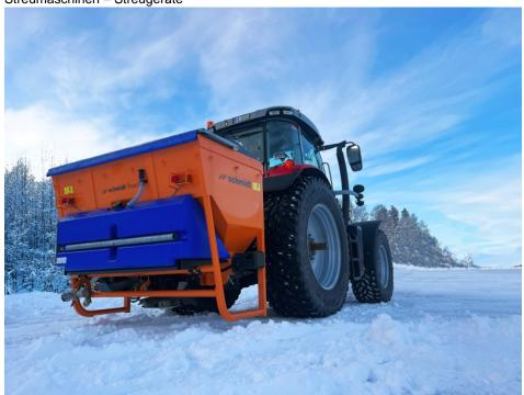
»Traxos«-Anbau-Streumaschine mit Feuchtsalzeinrichtung (Bild: Aebi Schmidt).
