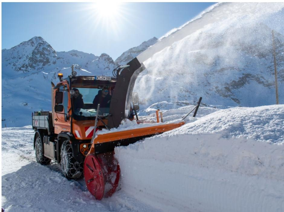
Die »FS HP«-Schneefräse von Schmidt montiert an einem Unimog im Einsatz für gründlich geräumte Verkehrswege (Bild: Aebi Schmidt).
