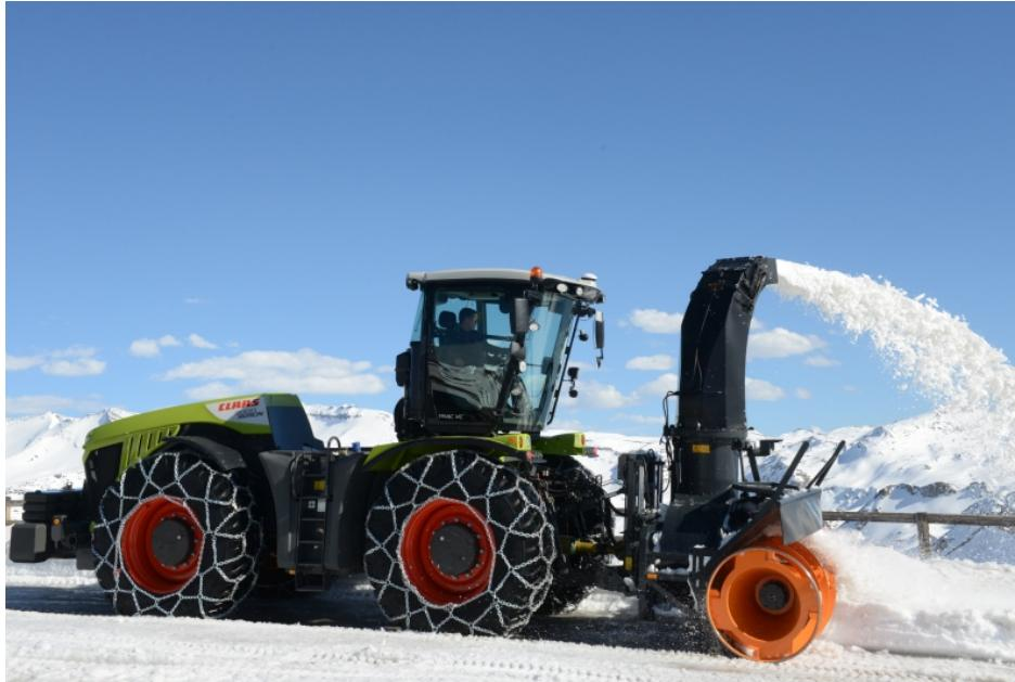
Die äußerst leistungsstarke Schneefrässchleuder »FS 110 T« ist mit dem Hochleistungsräumkopf von der »Supra 5002« ausgestattet und für die Montage an Geräteträger oder Traktoren vorgesehen (Bild: Aebi Schmidt).
