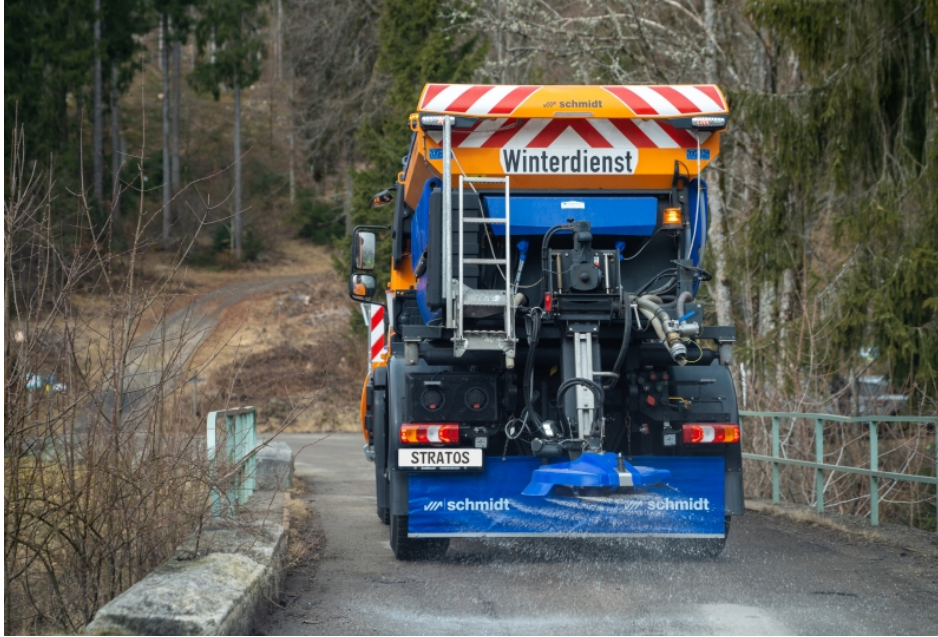
Ein »Stratos« aus der mittleren Baureihe, aufgebaut auf einen Unimog, bereit für den Wintereinsatz (Bild: Aebi Schmidt).
