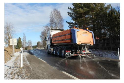
Für die Bekämpfung von Glatteis im Einsatz – die »Straliq«-Sprühmaschine (Bild: Aebi Schmidt).
