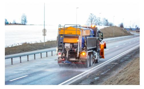
Der »Stratos Combi Soliq« ermöglicht das gleichzeitige Streuen und Sprühen mit einer Maschine (Bild: Aebi Schmidt).
