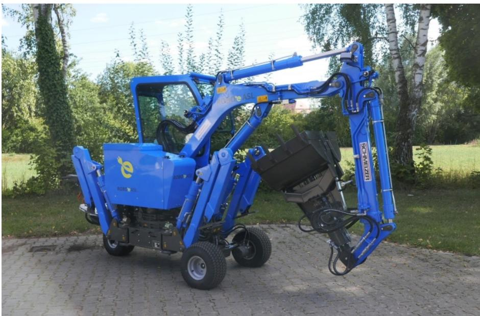
Der Elektro-Grabbagger hat 2 Fahrstufen oder ist per Anhänger auf öffentlichen Wegen umsetzbar (Bild: Schmelzer).
