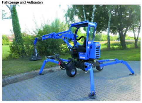
Der kompakte »ROBOe-ASL« ist für Weg ab 80 cm einsetzbar (Bild: Schmelzer).
