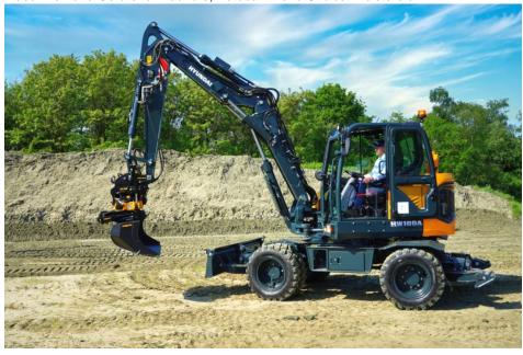
Der »HW100A« von Hyundai ist ein leistungsfähiger 10-t-Mobilbagger für den kommunalen Einsatz. Hier mit Schild- und Pratzenabstützung und Tiltrotator (Bild: Hyundai).
