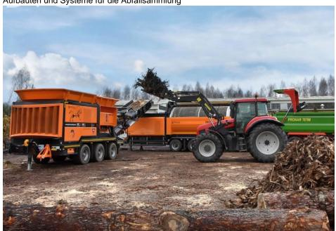
» Pronar MRW2.85 « in der radmobilen Version bei Zerkleinern von Grünschnitt. Ein eigener Antrieb des Fahrwerks sorgt für Mobilität am Einsatzort (Bild: Jürgen Kölsch).
