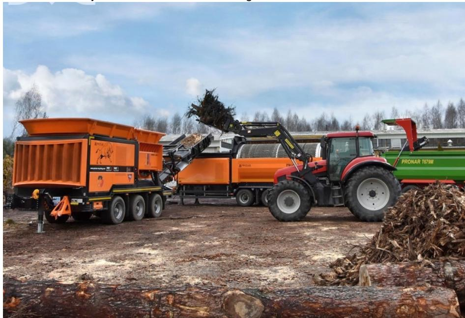
»Pronar MRW2.85« in der radmobilen Version bei Zerkleinern von Grünschnitt. Ein eigener Antrieb des Fahrwerks sorgt für Mobilität am Einsatzort (Bild: Jürgen Kölsch).
