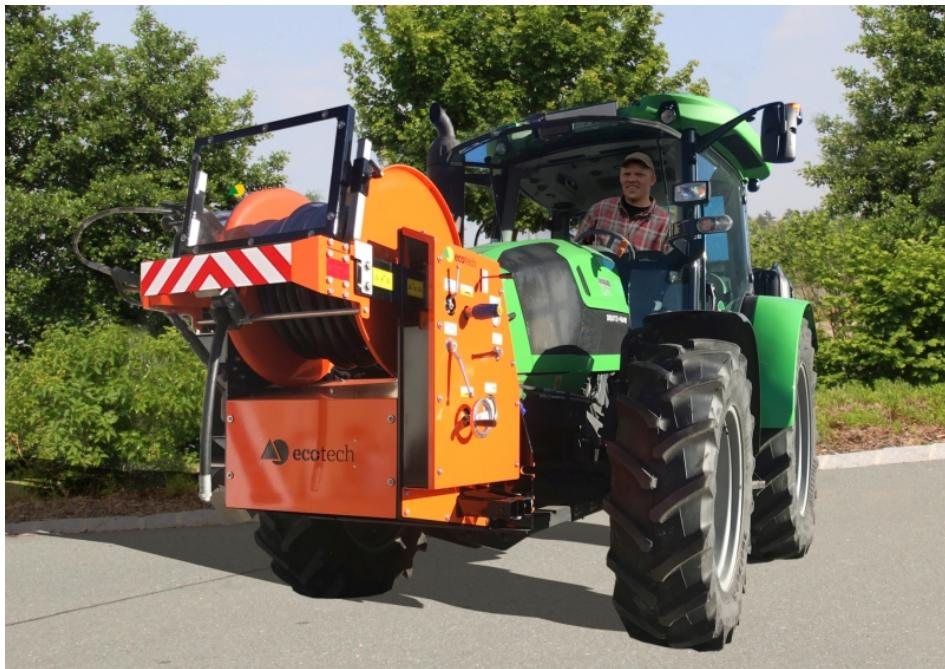
Das ecotech Kanalspülgerät »KSG« lässt sich an unterschiedlichen Trägerfahrzeugen wie Traktoren, Unimog oder Lkw betreiben (Bild: Eco Technologies).
