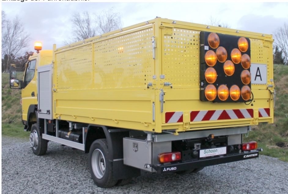
Schoon Fuso »Canter« als Dreiseitenkipper mit »VariaBoxx« und Laubgitteraufsatz (Bild: Schoon).
