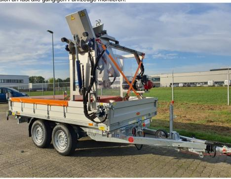
Die »ProClean«-Sinkkastenreinigung als Trailer-Lösung (Bild: SubTech)
