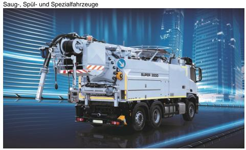
Mit seinem bis zu 270 Grad schwenkbaren Auslegersystem »Spacer« bieter der »Super 3000« größte Beweglichkeit (Bild: Wiedemann enviro tec).
