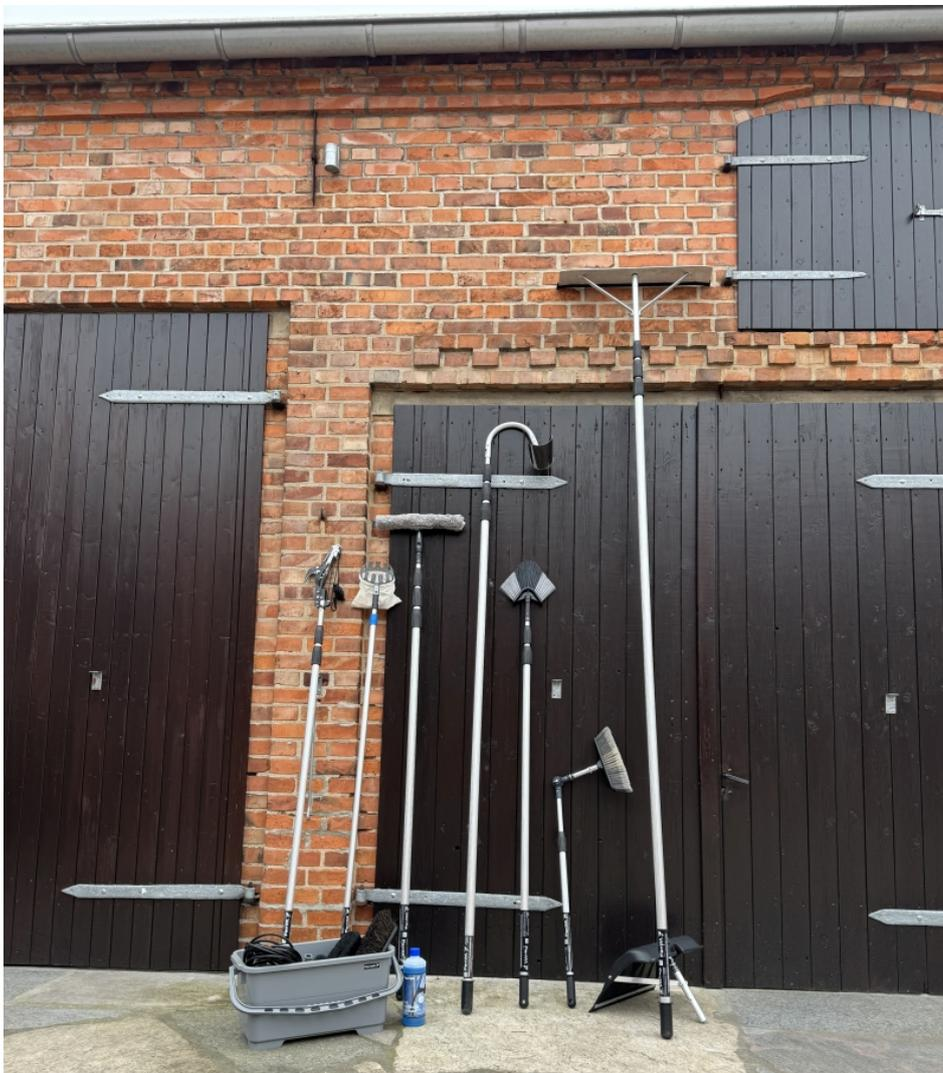
Die zahlreichen Anbaugeräte lassen sich einfach mit den Telekopstangen kombinieren und erschließen damit viele Einsatzgebiete (Bild: FenWi).
