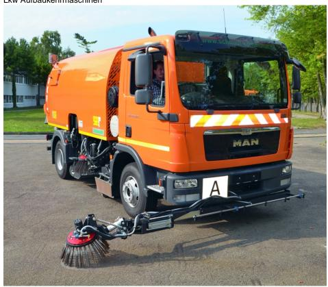
Zwei Kehraufbauten mit dem Namen »Themis « hat Schmidt Kommunalfahrzeuge für Lkw-Fahrgestelle im Programm - mit 4 oder 7 m³ Behältervolumen (Bild: Schmidt Kommunalfahrzeuge).
