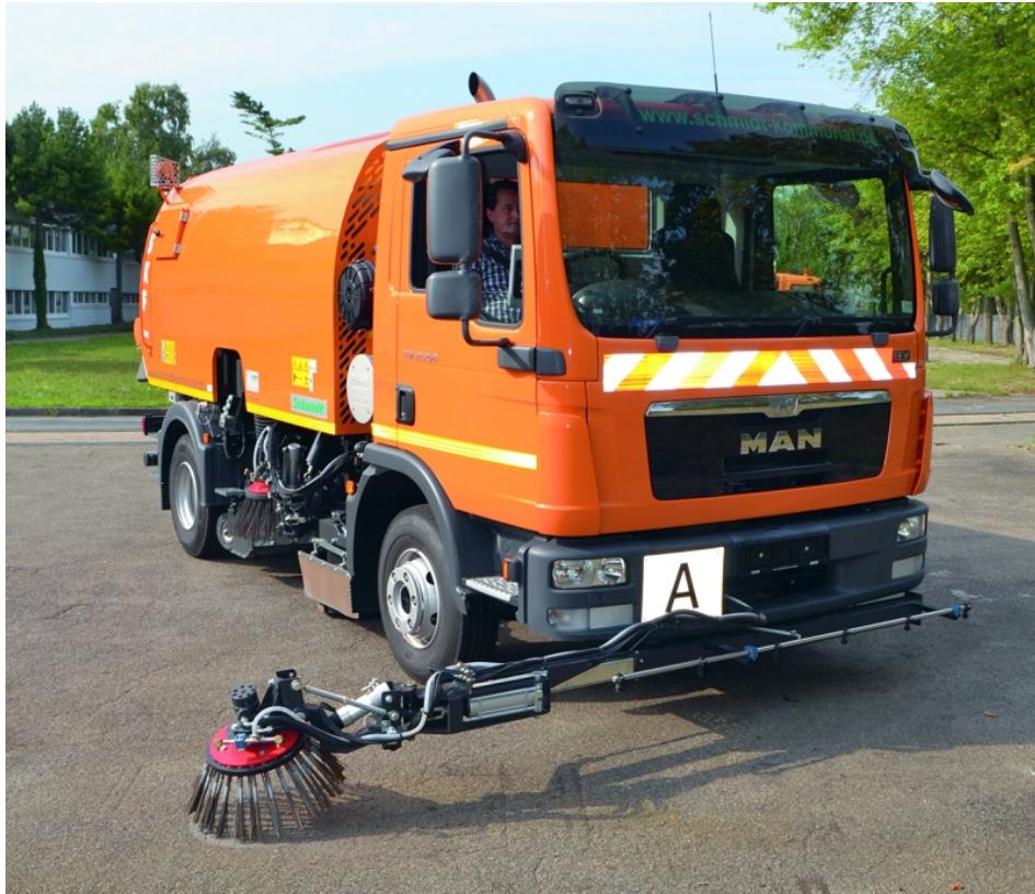
Zwei Kehraufbauten mit dem Namen »Themis« hat Schmidt Kommunalfahrzeuge für Lkw-Fahrgestelle im Programm - mit 4 oder 7 m<sup>3</sup> Behältervolumen (Bild: Schmidt Kommunalfahrzeuge).
