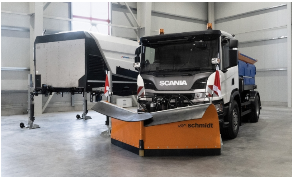
Trägerfahrzeug der Kehrmaschine »Street King 660« mit Streuer und Pflug für den Winterdiensteinsatz (Bild: Aebi Schmidt).
