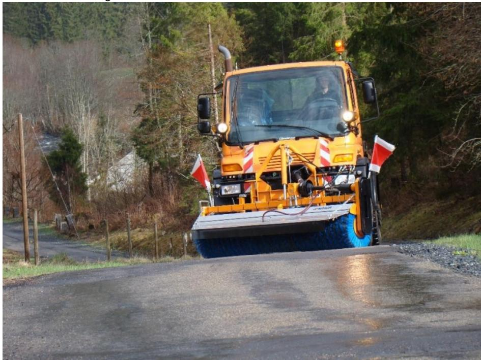
Die Anbaukehrmaschinen des Typs »LKS« und »VKS« (im Bild) bieten hohe Flächenleistungen (Bild: Aebi Schmidt).
