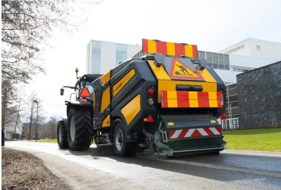
Die Anhängemaschine »Wasa 300+« kehrt auf einer Breite bis zu 2400 mm und sammelt das Kehrgut in einem 3 m<sup>3</sup> großen Behälter (Bild: Aebi Schmidt).
