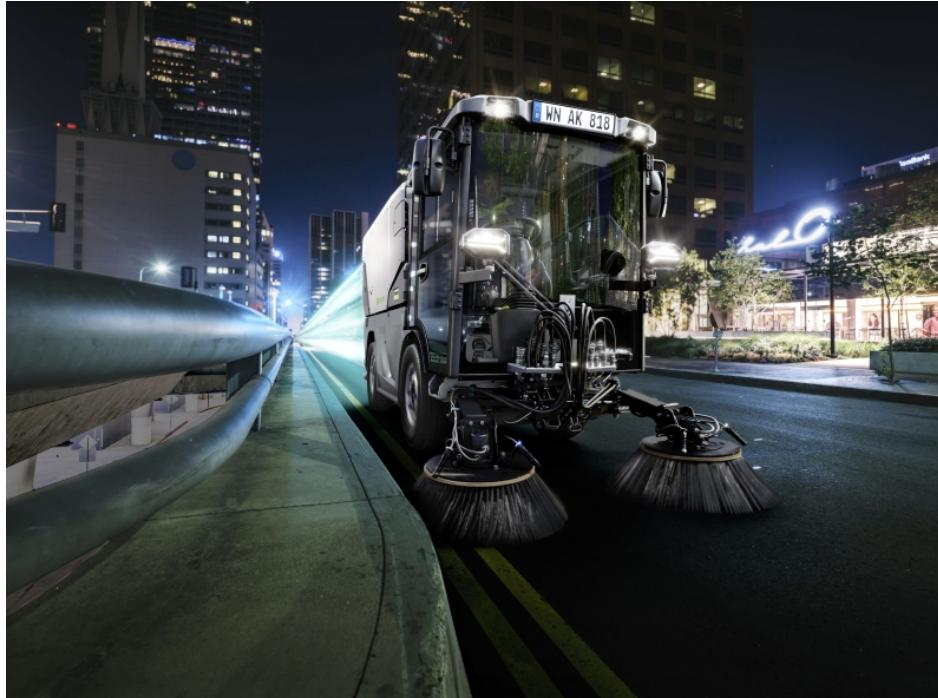
Längere Einsätze lassen sich dank hoher Batteriekapazität und einem Kehrgutbehälter mit 2,5 m<sup>3</sup> Volumen gut bewältigen (Bild: Kärcher Municipal).
