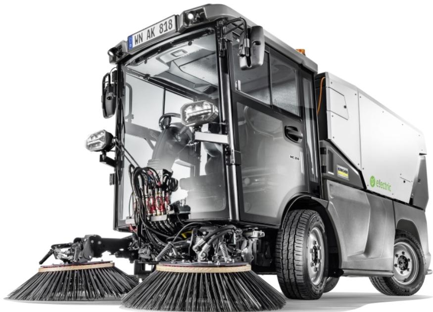
Die Elektro-Kehrmaschine »MC 250 electric« schafft mit einer Ladung eine Arbeitsschicht und verfügt über ein Wasserrecyclingsystem (Bild: Kärcher Municipal).
