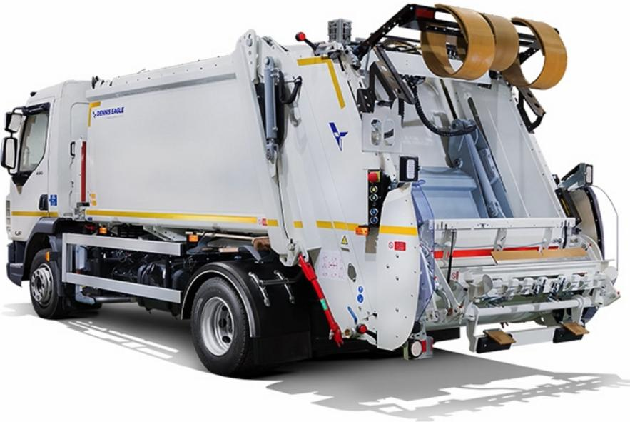
Der »Olympus Mini« ist nur maximal 2 m breit. Die Montage ist auch Fahrgestellen von 7,5 bis 11 t möglich (Bild: Terberg).
