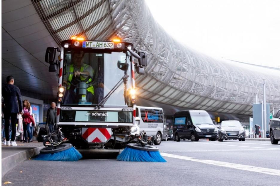
Die »eSwingo 200+« ist mit zwei unabhängigen Kehrsystemen erhältlich. Ein geschobenes 2-Besensystem mit Besendurchmesser 850 mm oder ein gezogenes 3-Besensystem mit Besendurchmesser 800 mm (Bild: Aebi Schmidt).
