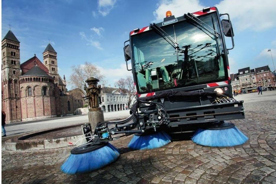
So arbeiten die Tellerbesen im Einsatz nicht einfach nur in der Schwimmstellung, sondern lassen sich überdies mit einem unabhängigen Bodenauflagedruck hydraulisch steuern (Bild: Aebi Schmidt).
