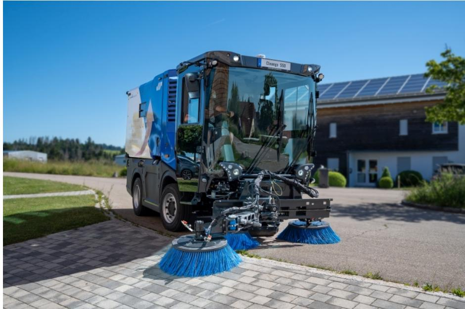
Der »Cleango 550« ist auch mit Elektroantrieb erhältlich und hat ein Systemvolumen von 5,2 m<sup>3</sup> (Bild: Aebi Schmidt).
