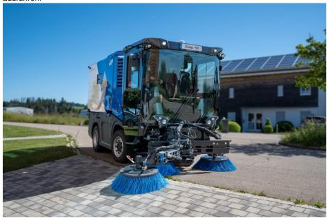
Der »Cleango 550« ist auch mit Elektroantrieb erhältlich und hat ein Systemvolumen von 5,2 m³ (Bild: Aebi Schmidt).
