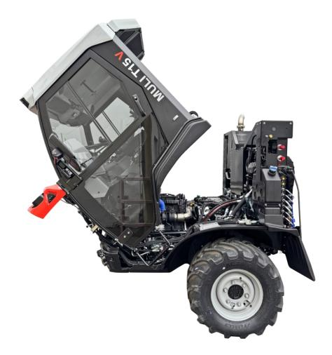
Die Kippkabine, die nach vorn kippt, sowie großzügige Wartungszugänge erleichtern die Instandhaltung des Fahrzeugs und verbessern die Zugänglichkeit für Wartungsarbeiten (Bild: Reform).
