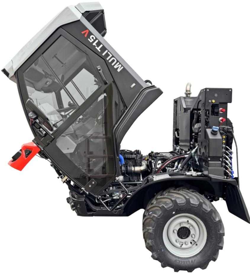
Die Kippkabine, die nach vorn kippt, sowie großzügige Wartungszugänge erleichtern die Instandhaltung des Fahrzeugs und verbessern die Zugänglichkeit für Wartungsarbeiten (Bild: Reform).
