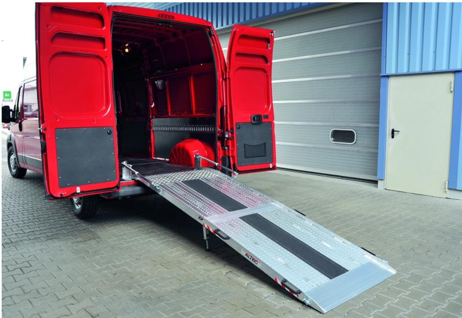
Verladeschiene Typ »RRK« hier als Sonderausführung mit Stützfuß und mittigem Korundbelag (Bild: Altec).
