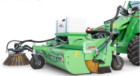
Kehrmaschine mit Wasserbehälter, Sprühsystem und Seitenbürste. Für jede Jahreszeit gibt es die passenden Anbaugeräte (Bild: Avant).
