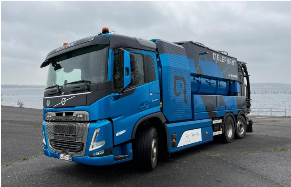
Der Aufbau erfolgt auf den Volvo Serien-Varianten FMX Electric, FM Electric, FM Low Entry, FE Electric und FL Electric mit verschiedenen Fahrgestellen und Radständen. Die Batteriekapazität kann in fünf Stufen mit bis zu 540 kWh ausgewählt werden, die Antriebsleistung ist zwischen 330 kW und 490 kW konfigurierbar.
