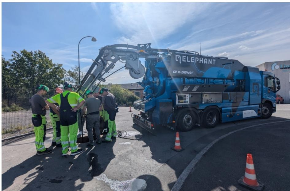
Die Leistung des elektrischen Saug- und Spülfahrzeugs als Recycler überzeugte im praktischen Einsatz auf einer Roadshow in 2024 – hier auf Station in Dänemark (Bilder: FFG Umwelttechnik).
