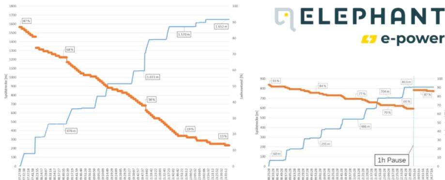
Die Diagramme zeigen den Verlauf des Ladezustandes in Bezug auf die zurückgelegte Spülstrecke.
