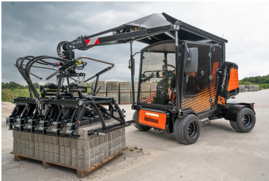
Die Pflasterverlegemaschine »PaveJet S24« verfügt als Cool Edition auch über eine Klimaanlage (Bild: Optimas).
