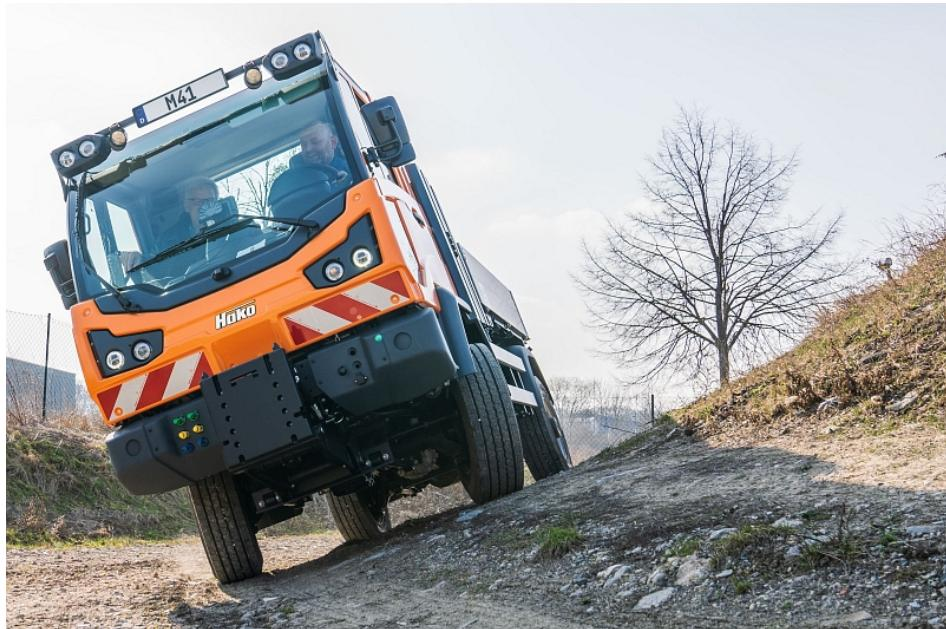
Der neue »Multicar M41«: multifunktionaler Lasten- und Geräteträger in der 7,5-Tonnen-Klasse (Bild: Hako).
