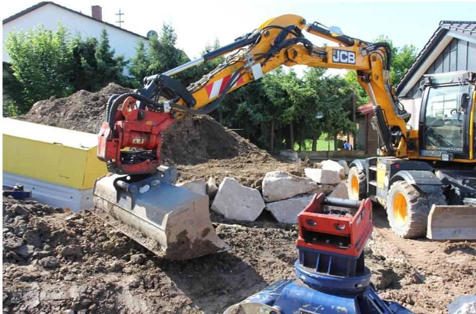
Mit dem »Powertilt«-Schnellwechsler sind Werkzeugwechsel eine Sache von Sekunden – eine echte Erleichterung bei komplexen Arbeiten Bild: Lehnhoff
