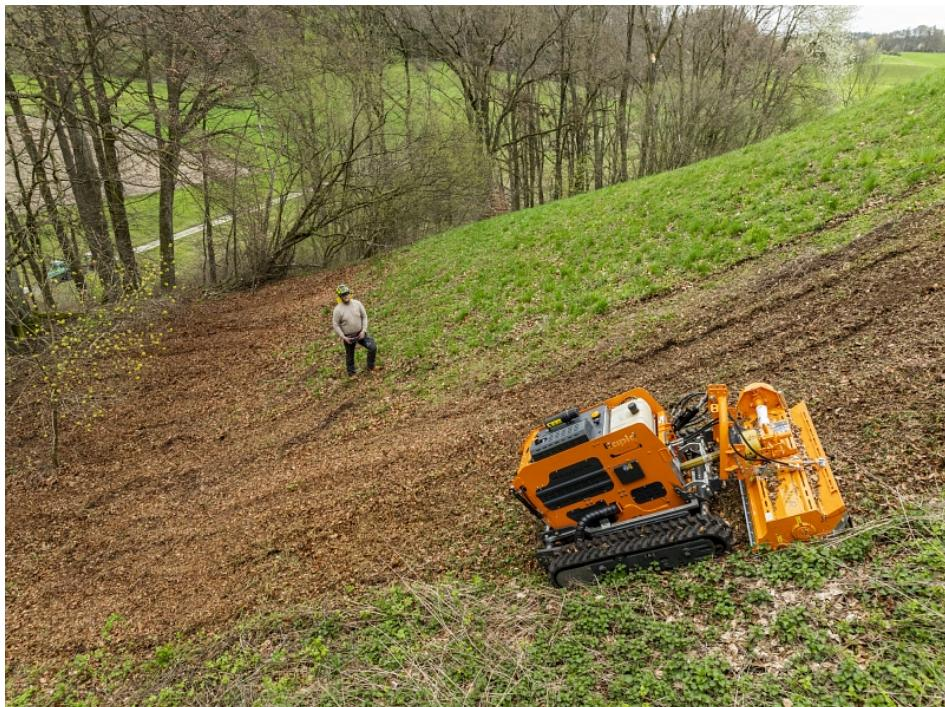
Klassische Anwendungen von dem »Vario D401« sind das Mulchen von Gras und Gestrüpp sowie mittelschwere Zapfwellenarbeiten (Bild: Rapid)
